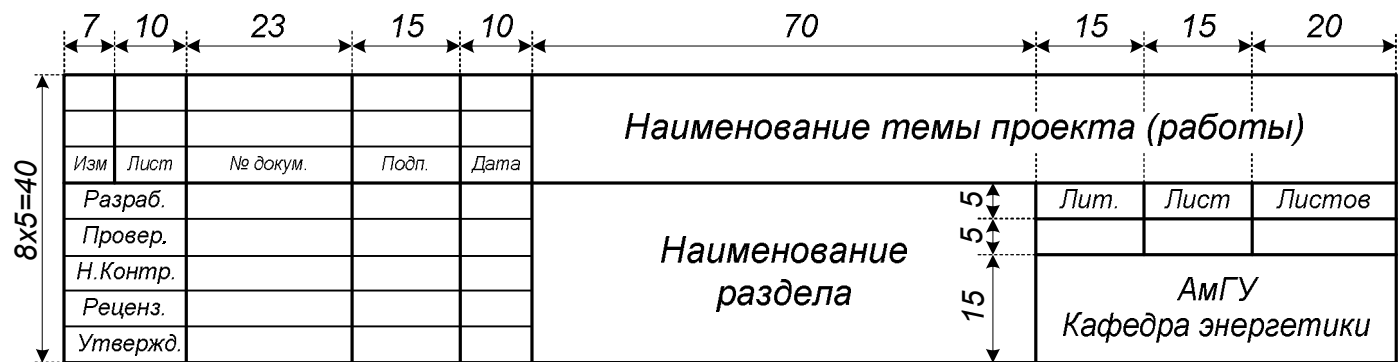
Рис. 28. Основной штамп для листа пояснительной записки.
