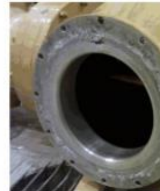
Рисунок 3 - нагрев контактного соединения в соединительном элементе
