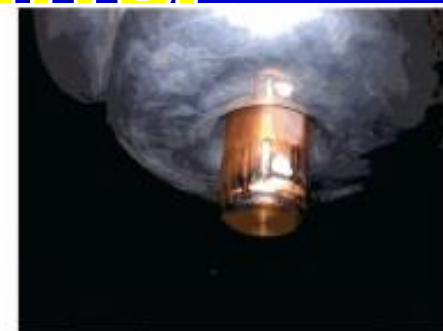
Рисунок 3 - нагрев контактного соединения в соединительном элементе
