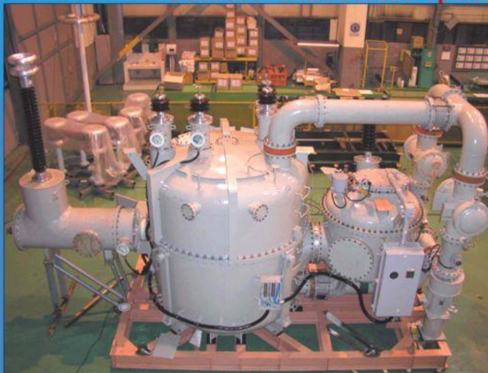
Силовой трансформатор 20 МВА, 154 кВ с элегазовым заполнением
