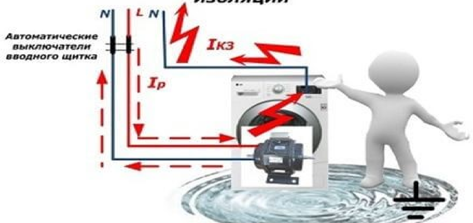
Схема работы системы зануления при пробое изоляции
