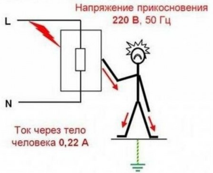
Корпус без заземления
