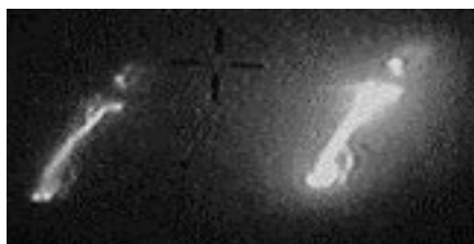
Рис.6.1. Изображение поверхностного частичного разряда на загрязненной и увлажненной поверхности при использовании фильтра – спектродиспергатора
