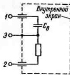
Рис. 5-23. Схема электростатического вольтметра
