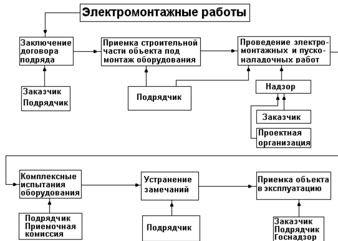
Рис. 1.1. Основные этапы проведения электромонтажных работ
