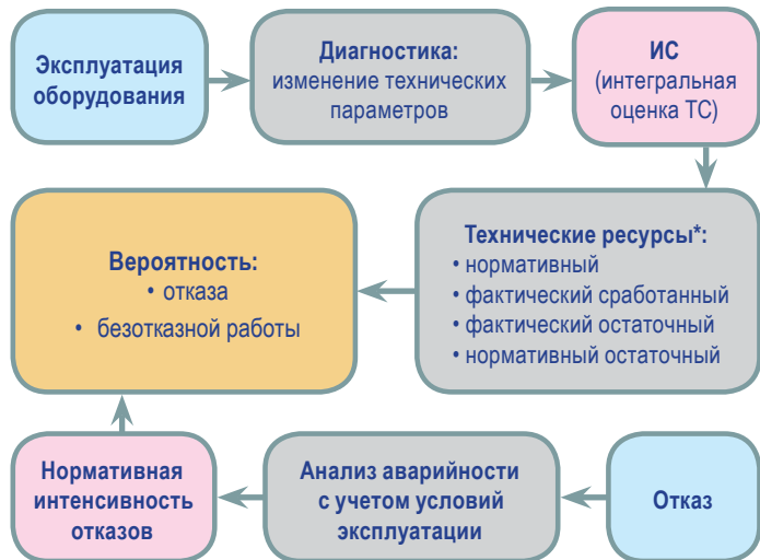
Рис. 1. Блок-схема определения вероятностей безотказной работы и отказа оборудования
