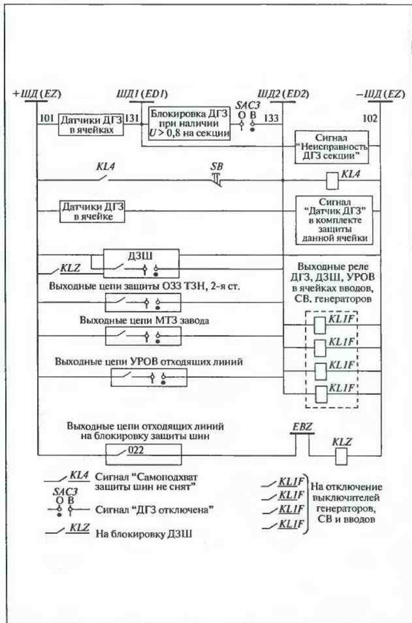
Рис. 3.3. Схема организации целей защиты шин КРУ
