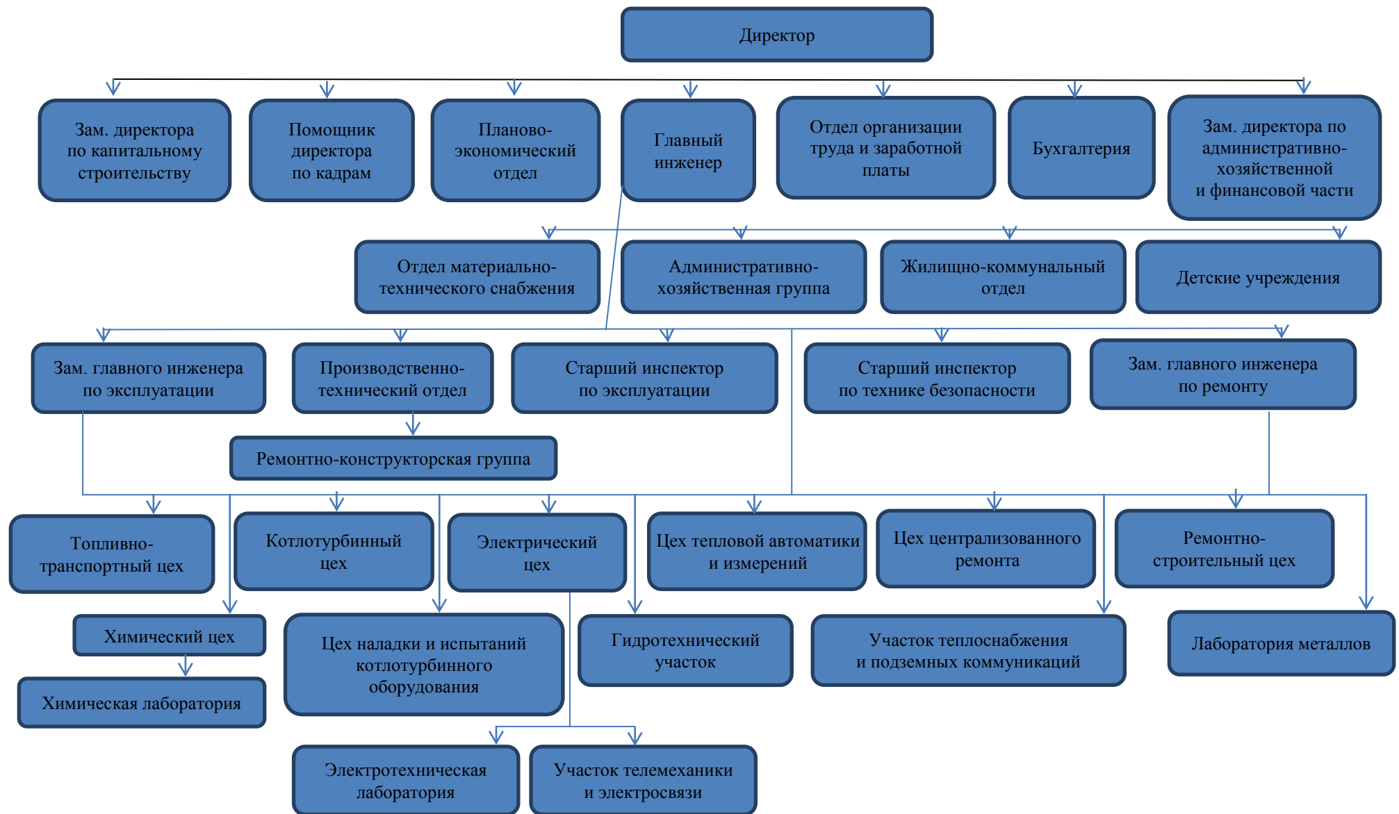
Рис. 2. Организационная структура управления тепловой электростанцией с энергоблоками мощностью 300 тыс. кВт, работающей на угле
