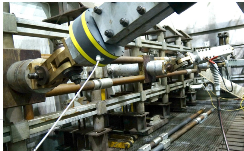
Генераторный выключатель на 210 кА generator circuit breaker 210 kA
