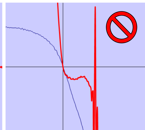
Если ток после прекращения дуги > 70 м, прерывание не состоялось post-arc current > threshold interruption fails
