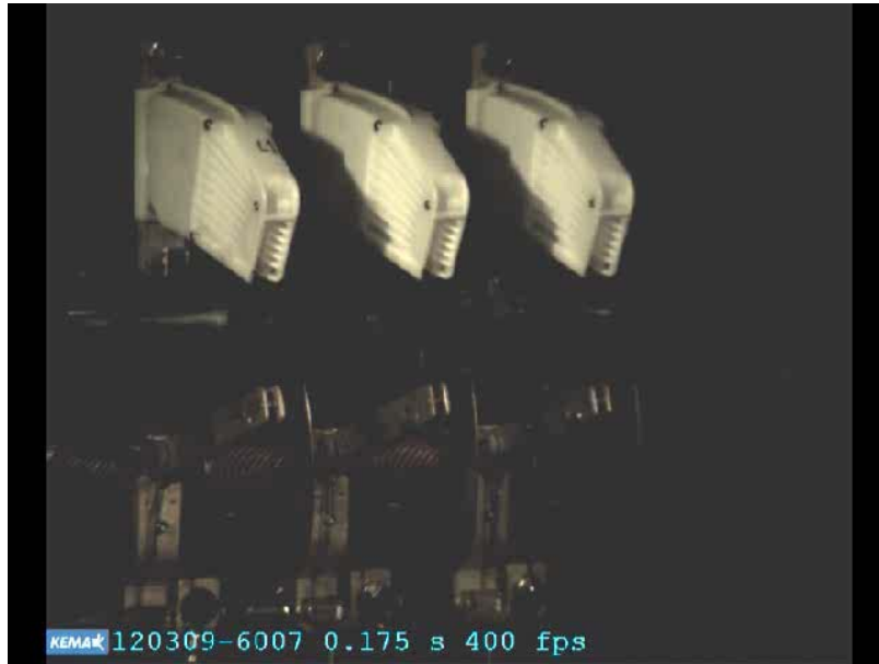
выключатель нагрузки 12 кВ 700А load break switch 12 kV 700 A
