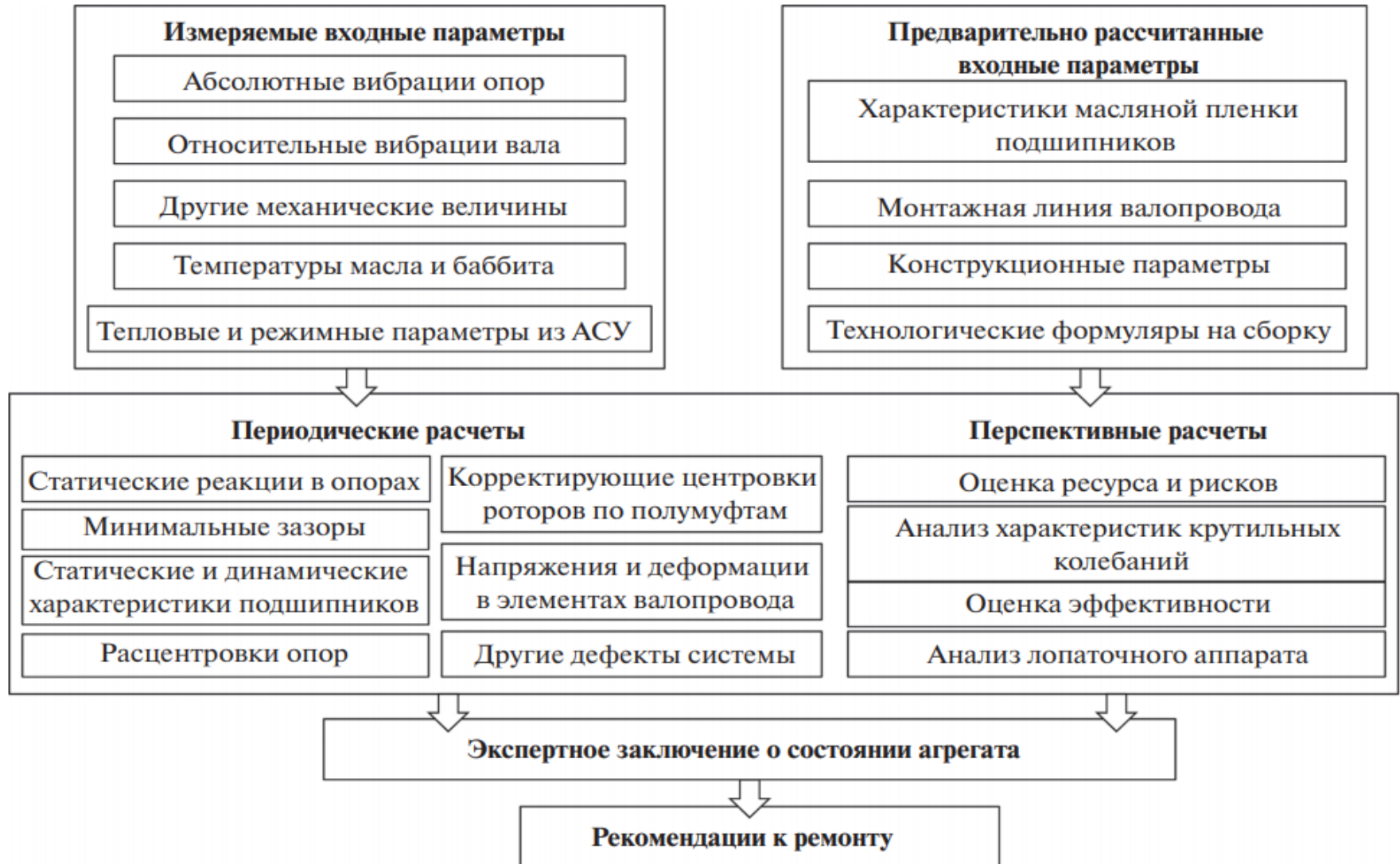
Рис. 3. Блок-схема системы мониторинга технического состояния КОМПАКС-Т
