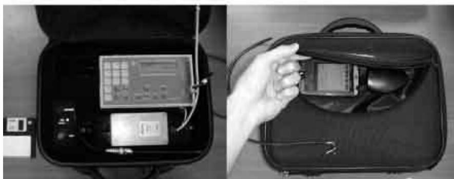
Рис. Прототип мобильного АРМ метролога в кейсе
