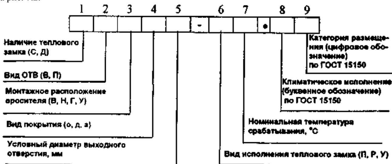
Рис. 7.2. Структура обозначений оросителей и их маркировка. Для дренчерных оросителей поз. 6 и 7
