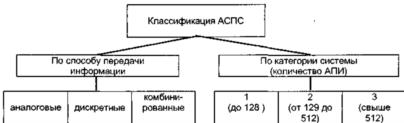
Рис. 2.2. Классификация адресных систем пожарной сигнализации
