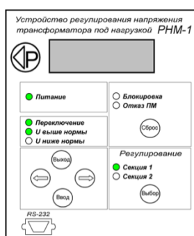
Рисунок 28. Блок автоматического регулирования положения РПН трансформатора.
