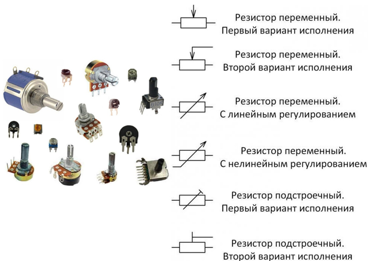
Рисунок 1.2 – Переменные резисторы и варианты их исполнения
