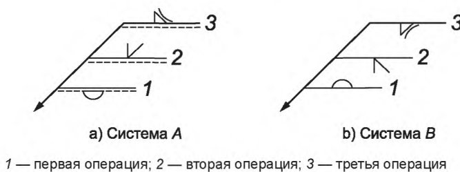
Цифры 1, 2 и 3 показаны, чтобы указать порядок операций сварки и не должны располагаться на чертежах.
