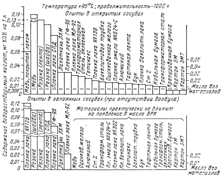
Рис. 10.2. Влияние изоляционных и конструктивных материалов на появление водорастворимых кислот в трансформаторном масле
