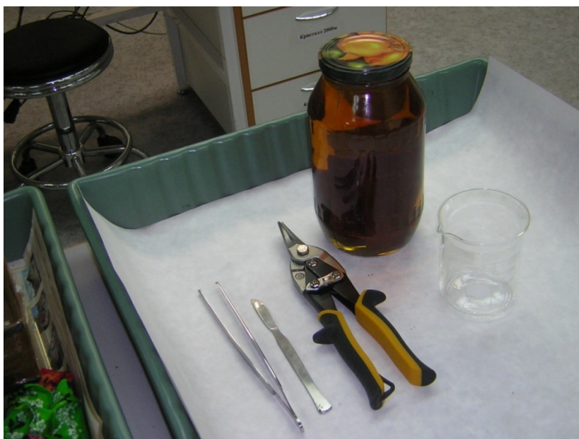
Рисунок Б-3 – Стекланный сосуд с завинчивающейся крышкой с образцами целлюлозной изоляции в масле и подготовленное рабочее место
