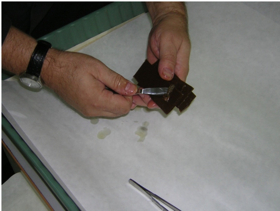
Рисунок Б-6 – Разрезание шнура, связывающего образец
