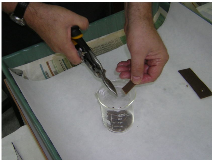
Рисунок Б-10 – Подготовка навески образца изоляции
