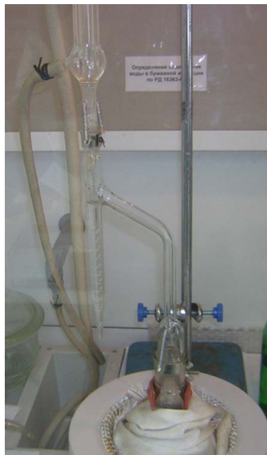
Рисунок Б-2 – Аппарат АКОВ-10 в вытяжном шкафу в процессе кипячения уайт-спирита (верхняя часть колбы закрыта стеклотканью)
