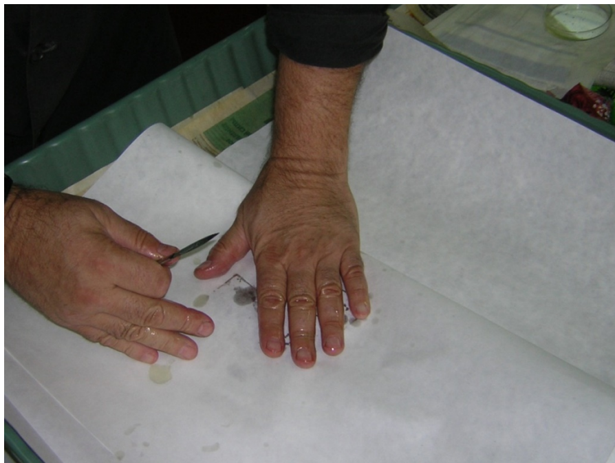
Рисунок Б-7 – Протирка образца фильтровальной бумагой
