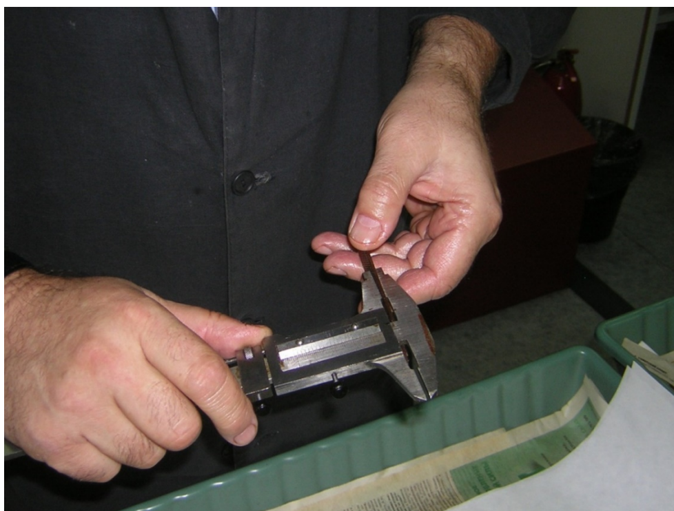
Рисунок Б-9 – Измерение толщины образцов изоляции
