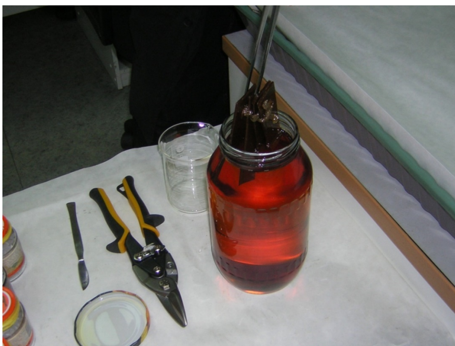
Рисунок Б-5 – Извлечение образца целлюлозной изоляции из сосуда
