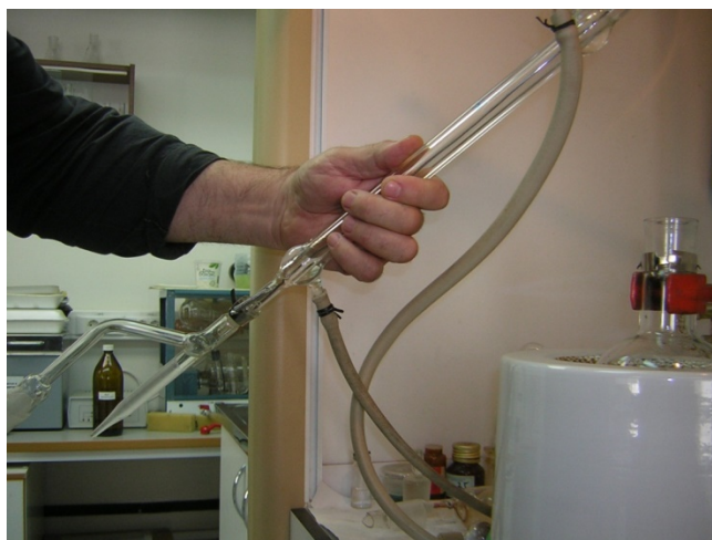
Рисунок Б-15 – Удаление холодильника с ловушкой (справа открытая колба в колбонагревателе)
