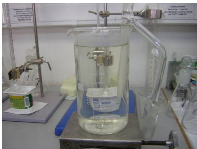
Рисунок Б-16 – Ловушка, помещенная в стакан с горячей водой
