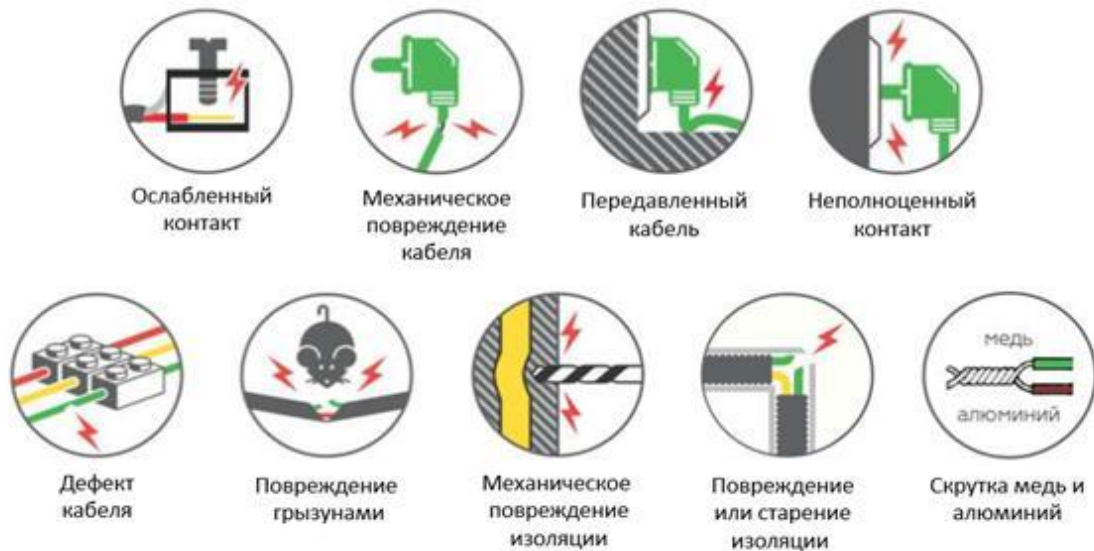
Рисунок 6. Возможные причины искрения в электропроводке
