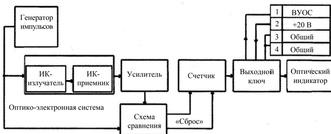
Рис. 1.3. Структурная схема извещателя ИП 212-45
