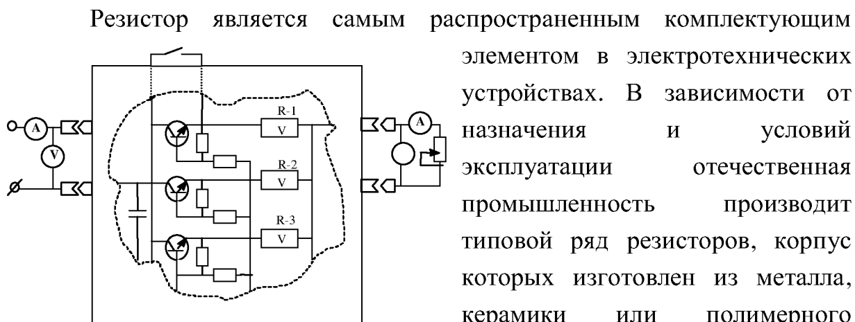
Рис. 3. 1 Фрагмент схемы платы ПСТ-01 в блоке ВВП-01
