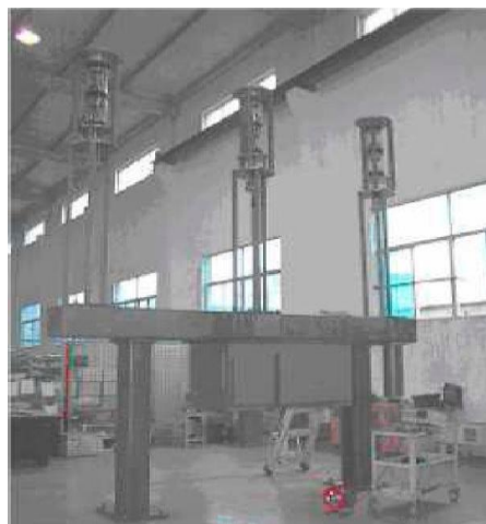
Рисунок 4.6 – Вакуумный высоковольтный выключатель с одинарным разрывом цепи напряжением 126 кВ/40 кА/2 кА
